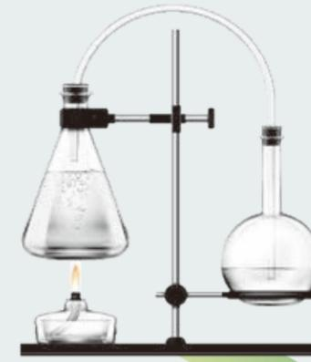
一例ですが、生松脂を蒸留して、精油を抽出します。
