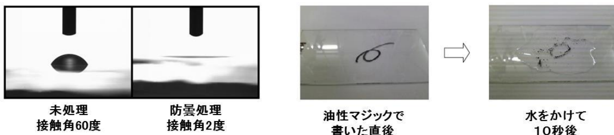
図4. 表面処理されたガラスの水の接触角と油性マジックによる防汚試験
